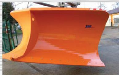
Pluge izdelujemo v **velikosti od 1,5 do 3,4 m** z ali brez mehanizma za dviganje. Pri ravnih in vario plugih na **željo kupca** vgradimo dodatni hidravlični cilindar za prisilno nagibanje pluga, ki se ga uporablja za pluzenje pločnikov.
